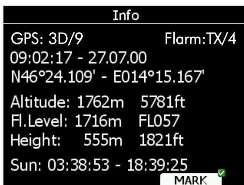
**Altitude** ist die Höhe über NN, **Fl. Level** die Höhe über 1013 hPa und **Height** die Höhe über dem Geländemodell. In der rechten oberen Ecke wird der Flarmstatus angezeigt. TX bedeutet, daß das integrierte Flarm aktuell sendet, die Nummer zeigt die Anzahl der empfangenen Flarmobjekte an.
