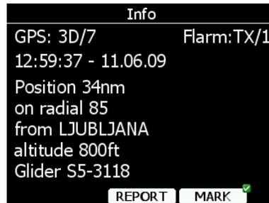
Radials sind immer magnetisch, und die Entfernung wird immer in nautischen Meilen (NM) angegeben, unabhängig von der Einstellung unter Units (3.3.11). Mit “MARK” wird die aktuelle Position gespeichert, siehe vorangegangener Abschnitt.
