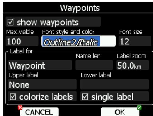
Mit dem UP/DOWN-Drehschalter (rechts unten) ändert man die Schriftart. Der entsprechende Text wird gleich in der passenden Schriftart dargestellt. Mit dem Zoom-Drehschalter (links unten) ändert man die Farbe der Schrift.
