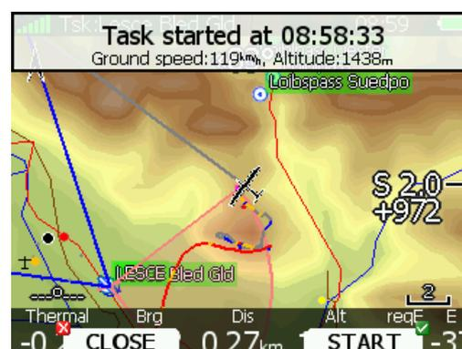
In der unteren Zeile werden zwei Menüpunkte angezeigt: **CLOSE** verwendet man, wenn man nicht abfliegen möchte (z.B. zu hoch oder zu schnell). Hat man die Startmeldung mit **CLOSE** weggeklickt, erscheint sie automatisch beim nächsten Überflug erneut. Verwenden Sie **START**, wenn Sie tatsächlich abfliegen wollen, die Navigation schaltet nun auf den ersten Wendepunkt um.
