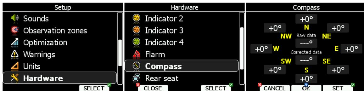
1.) Richten Sie das Flugzeug nach Norden aus. Das N Label wird automatisch ausgewählt.
