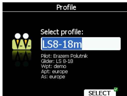
Sind mehrere Profile vorhanden, können Sie jetzt eines davon mit dem UP/DOWN-Drehschalter auswählen und mit SELECT aktivieren. Für das ausgewählte Profil werden die hinterlegten Datenbanken, Flugzeugtyp, Pilotenname angezeigt. (→ 3.1.2 und 3.3.14)
