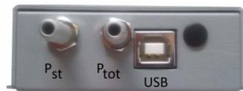
Schließen Sie die Box nun den statischen Druck und den Gesamtdruck an, wie auf der Box beschriftet. Der Anschluß an das LX8000 erfolgt über ein USB-Geräte Kabel (im Lieferumfang)
