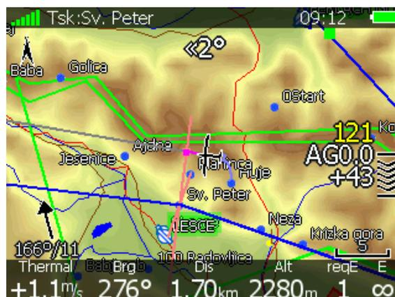
Die untere Zahl gibt die Differenzhöhe, mit der man den, zur aktuellen Position nächstgelegenen Punkt der Linie erreicht, bei der aktuell geflogenen Groundspeed, die in der gelben oberen Zahl angezeigt wird. Bei positiven Differenzhöhenwerten käme man zu hoch an. Die Chevrons geben jetzt an, daß man noch beschleunigen kann, bzw. langsamer fliegen sollte. Auf dem Beispielbild oben ist der Pilot aktuell 121kmh/h über Grund schnell und käme 43m oberhalb der Linie an
