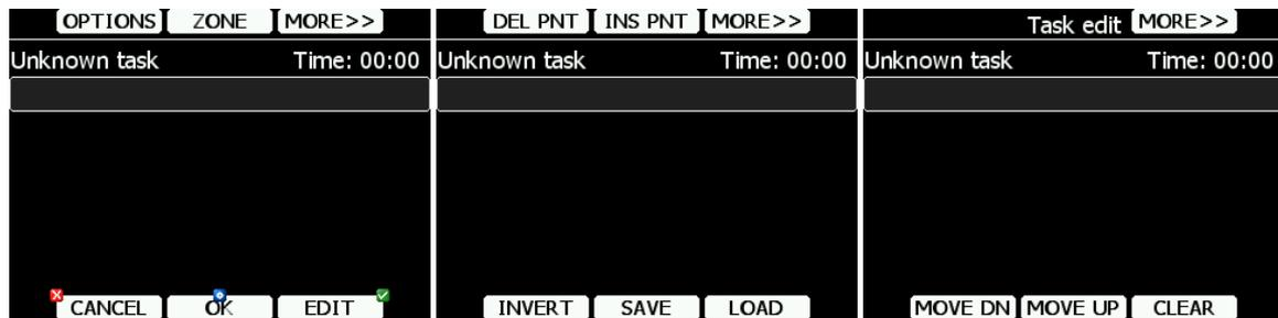
Die einzelnen Funktionen sind wieder auf die Drucktaster verteilt, das Drücken eines Drucktaster aktiviert die Menüs. Da es deutlich mehr als sechs Funktionen gibt, geht es wieder mit MORE>>, zu weiteren Funktionen. Hier eine Übersicht der verfügbaren Möglichkeiten:
