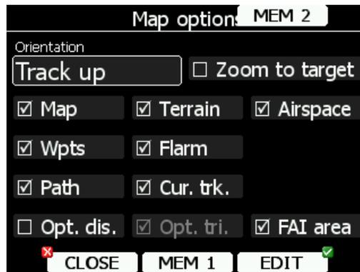
Wenn **Zoom to target** aktiviert ist, wird die Zoomstufe automatisch so eingestellt, daß das Ziel immer sichtbar ist. D.h. die Zoomstufen werden 200km (Maximum) bis zum Erreichen des Ziels auf 1km (Minimum) heruntergestellt. Wird zwischendrin jedoch manuell gezoomt, so wird der automatische Zoom beendet.
