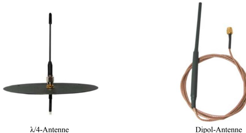
Die **Dipolantenne** enthält Antenne und Gegengewicht in Stabform (eigentlich genau genommen ein Sperrtopf), sie ist **Standardlieferungsumfang**. Hier sollte die obere Hälfte (Strahler) aus der Panelabdeckung ragen (quasioptisch freie Sicht). Wird als Panelabdeckung Kohlefaser verwendet muß alles auf der Oberseite installiert werden
