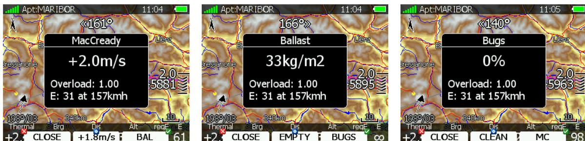
Mit dem UP/DOWN-Drehschalter können Sie die einzelnen Werte verstellen (→ 3.5.1.5.3)
