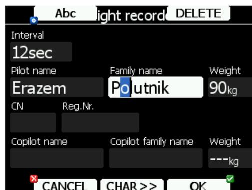
Drücken Sie **CHAR>>**, um den Cursor eine Position nach rechts zu bewegen. Der Cursor kann ebenfalls mit dem **ZOOM**-Drehschalter (unten links) bewegt werden, und zwar in beide Richtungen. Drehung im Uhrzeigersinn
