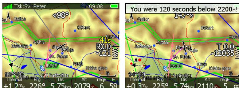
Die untere Zahl ist jetzt die Differenz zur eingestellten Grenzhöhe. Negative Werte bedeuten, daß Sie unter dieser Höhe sind. Die obere Zahl (in gelb) ist die Zeit, die noch unterhalb der eingestellten Höhe verbracht werden muß (zählt herunter). Die Chevrons sind in m Differenz zur eingestellten Höhe definiert, jedes steht für 10m. Die Meldung: "You were XX seconds below YYYYm! gibt Ihnen an, daß Sie die Bedingungen erfüllt haben und nun abfliegen können.
