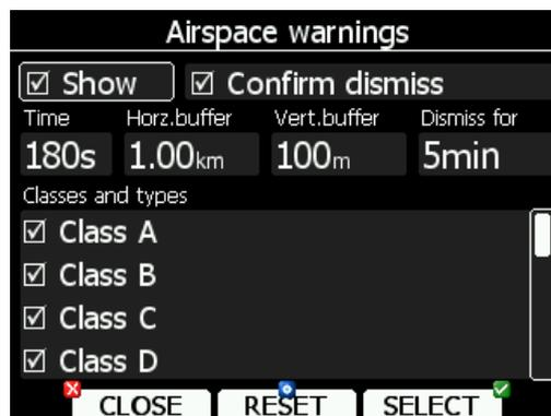
Um einen Luftraum herum definiert der Pilot eine Sicherheitszone mittels der Werte „**Horz. Buffer**“ (lateraler Abstand, x siehe Bild) und „**Vert. Buffer**“ (vertikaler Abstand, z siehe Bild).
