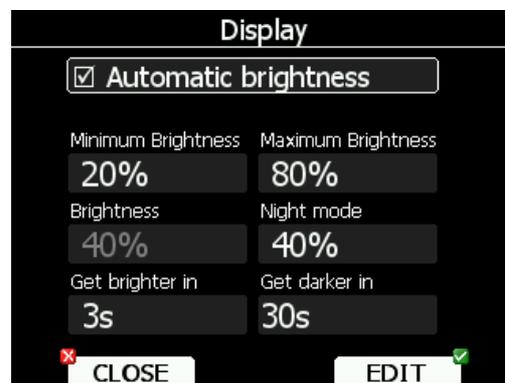
„Automatic Brightness“ kann mit EDIT ein- und ausgeschaltet werden.
